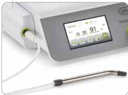
プローブから磁気パルスをスマートペグに発信し、共振周波数を測定することによりISQ値を算出。非接触のため直接インプラントやアパットメントに衝撃を与えずに測定可能。
