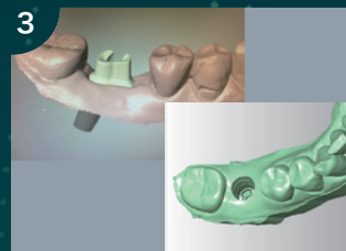
CADにて補綴物をデザイン後 モデルビルダーにて模型データ作成 (DTIにて模型データ作成可能)
