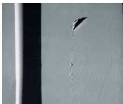
図2 - SEM像50× アバットメントとフィクスチャーがベベルとHexにて 緊密に接触している。
