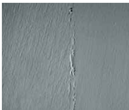
図3 - SEM像150× Friction-FitしたHex部。冷間圧接状態で接触して いる。
